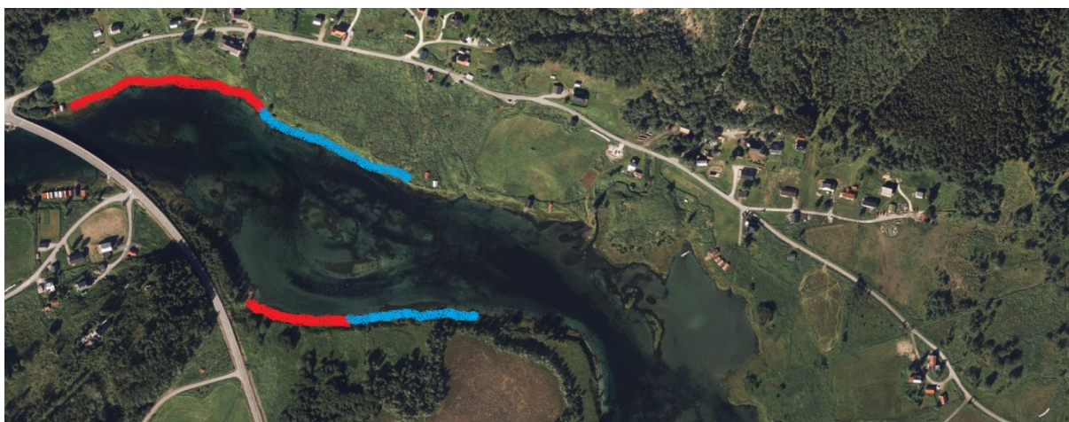
Figur 6-10 Illustrasjon av areal med motfylling (rødt) og areal med mulig erosjonssikring (blått).
