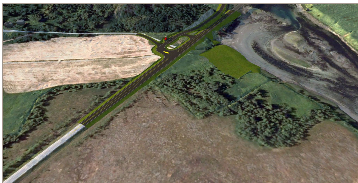
Figur 5-9 Bilde fra modell som viser vegtiltak og motfylling.
