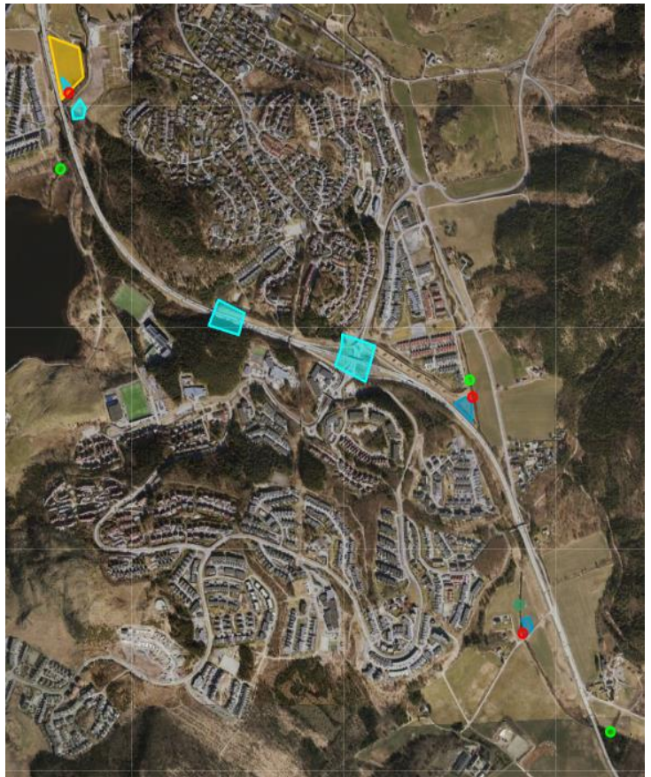
Figur 3 – Oversikt over tiltaksområdet. Prøvetakingspunkter for resipientundersøkelsen er merket i grønn (nytt prøvepunkt merket i mørk grønn). Utslipp fra sedimenteringsbasseng (mørk blå) til Høylandsåna og Bråsteinskanalen er merket i rødt, og skal overvåkes kontinuerlig. Rensecontainere er oppgitt i lys blå og massedeponi i gul. Kartgrunnlaget er fra Temakart Rogaland, 2023. Figurer er basert på opplysninger i søknaden..
