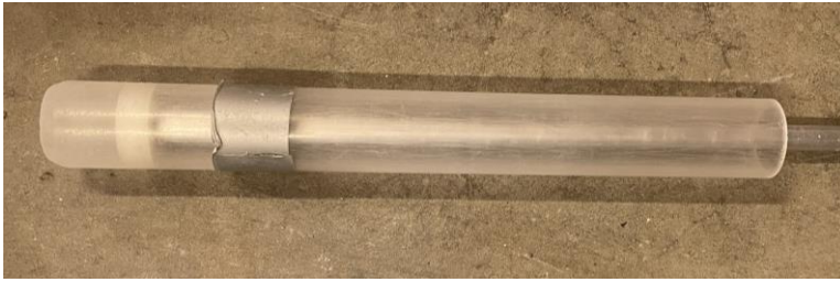
Figur nr. 1. Corer med stempel benyttet ved undersøkelsen.
