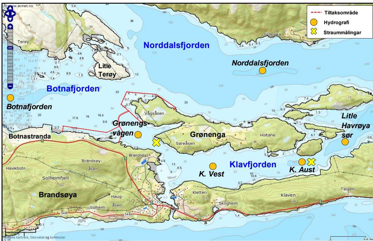
Figur 10. Oversikt over prøvetaking i sjøområda rundt planområdet for basisframlegget Sandvikskjeret-Brandsøya og alternativ 2, Grønenga, med stasjonar for hydrografi og straummålingar. Kartgrunnlaget er henta fra [www.kystverket.no](http://www.kystverket.no).
