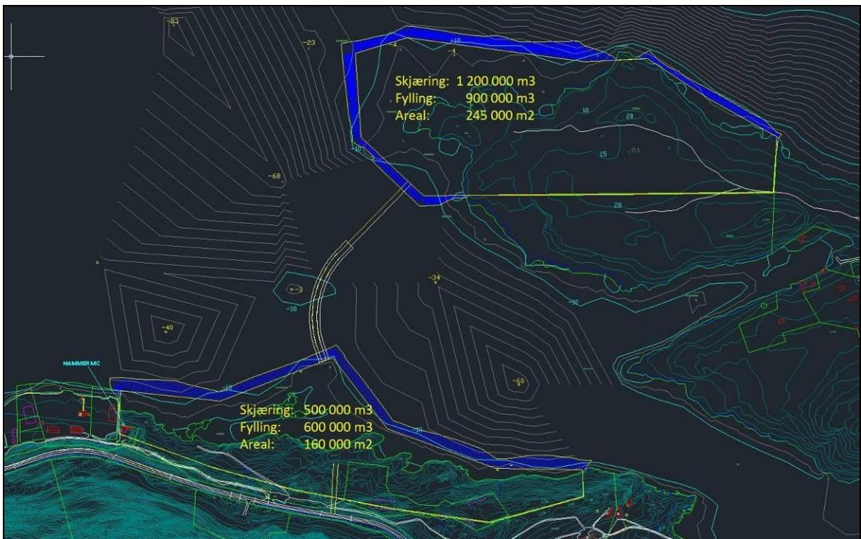
*Figur 7. Tidlegare Alternativ 1-2, Sandvikskjeret-Brandsøy og Grønenga. Opphavleg planforslag for utfylling, veg og brusamband.*
