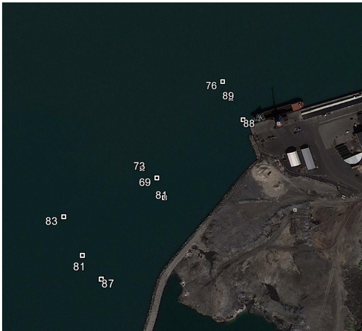
Figur 6. Resultatene fra prøver av sedimentene. Tallene i kartet angir hvor stor andel av sedimentet som var finkornet (partikkel diameter mindre enn 63\ \mu\text{m} ).
