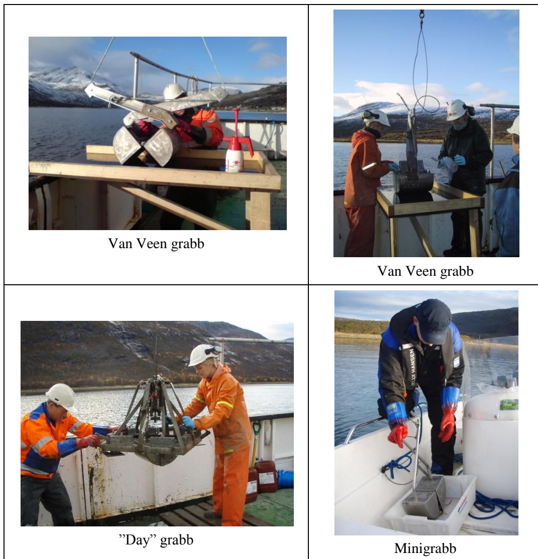
Figur 1 Standard Van Veen grabb med "inspeksjonsluker" hvor prøver blir tatt ut, "day" grabb på stativ og håndholdt minigrabb.
