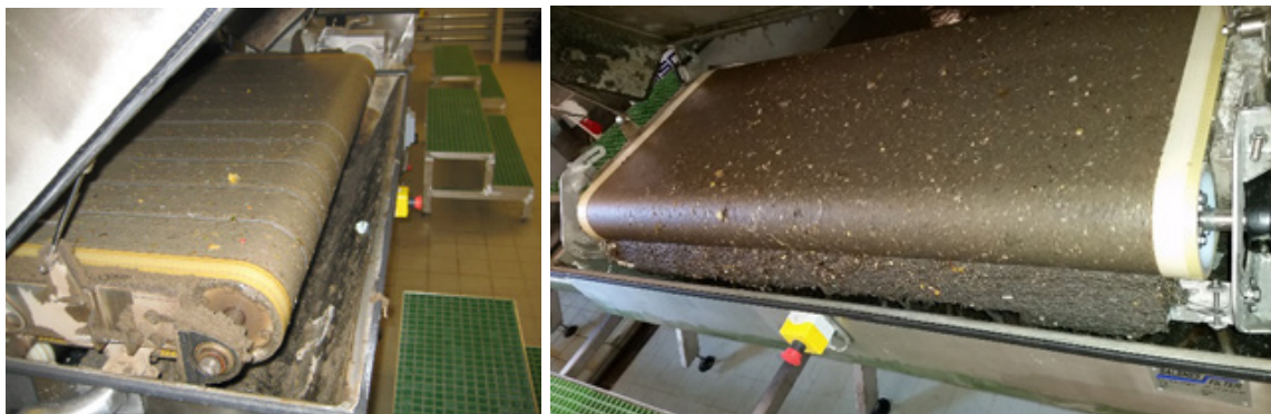
Bilde 3: Sil før ombygging til venstre og bilde av skrape etter oppbygging til høyre
