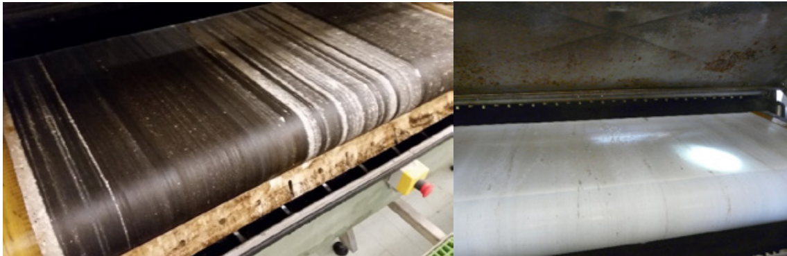
Bilde 6: Bildet viser hvordan asfaltstøv tetter silduken til venstre og en ren duk til høyre
