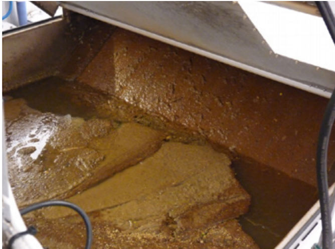
Bilde 1: Eksempel på punktbelastning foran sil.
