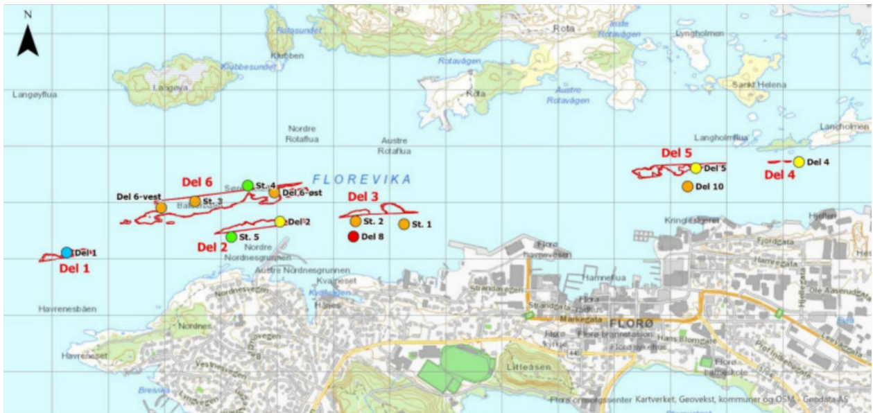
Figur 1 Oversikt sedimentprøver tatt ved/i utdypingsområder av Multiconsult (2012) og Rambøll (2020). Høyeste tilstandsklasse er markert. Fargekode på punkter; blå= bakgrunn, grønn= god tilstand, gul= moderat, orange= dårlig og rød= svært dårlig- den mest forurensete prøven (del 8) ble tatt sør for tiltaksområdet 2014.
