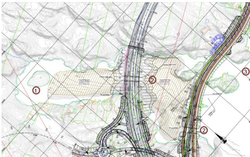
Figur 6 Forslag til plassering av automatiske målestasjoner. 1 er målestasjon ved ålegress, det er vist to stk. av måler nr. 2 og det viser bare mulige plasseringer, at denne kan flyttes etter hvor arbeid foregår. Måler 3 er referansestasjon og skal stå i god avstand til anleggsområdet
