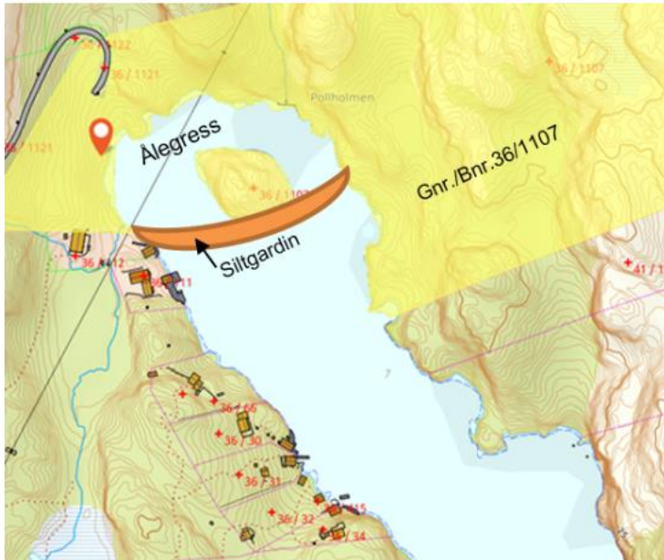
Figur 5 Området som vil berøres midlertidig med siltgardiner innerst i Arefjordpollen, og tilsyn av disse. Siltgardin er skissert med oransje figur
