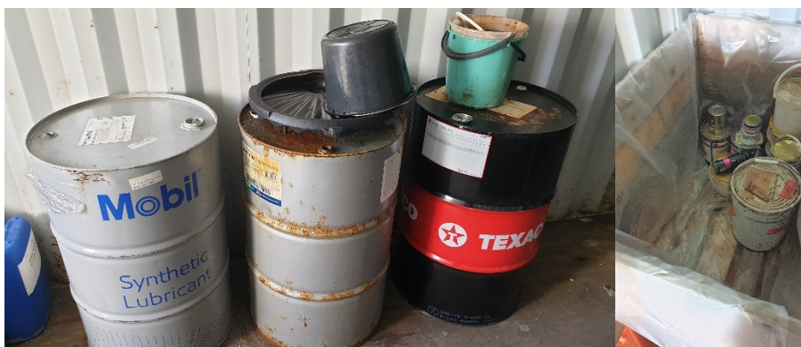
Figur 1. Umerket farlig avfall. Tønner m spillolje ikke sikret mot lekkasje.
