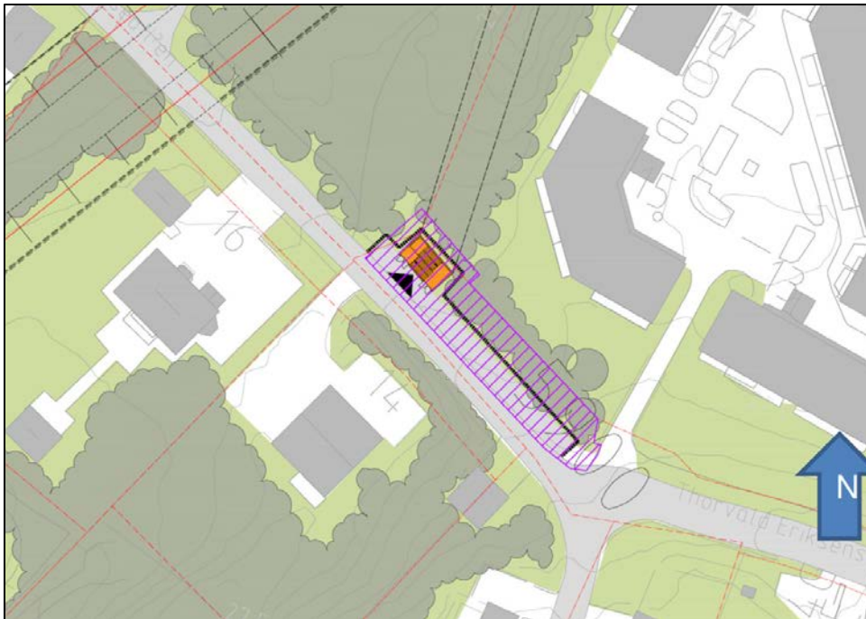
Figur 1 Rømningsstunnel med oppgang ved Prinsessealléen. Foreløpig plassering av rigg- og anleggsareal er markert med lilla. Figuren er hentet fra forprosjekt utført av Norconsult [7].
