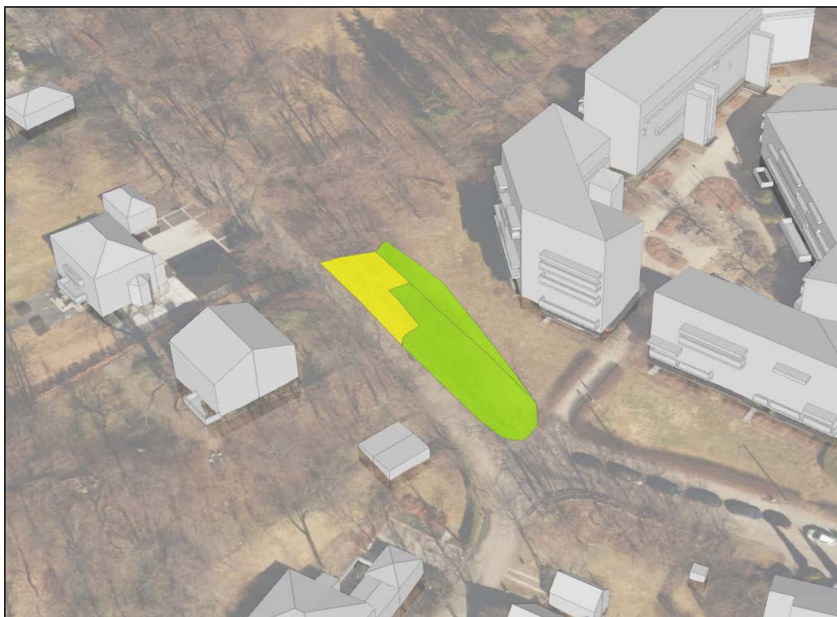
Figur 3 Utsnitt fra GIS-modell for rømningstunnelen i Prinsessealléen utarbeidet av Prosjekteringsgruppen Fornebubanen. Gult og grønt område viser henholdsvis til permanent og midlertidig grunnerverv. Gravegrova etableres på det gule området og riggområde på det grønne området. Utsnittet er hentet ut 07.02.2020.
