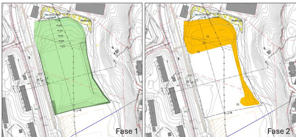
Figur 8. Områder med topplag av sprengstein som følge av videre utfylling av området. Til venstre vises sprengsteinsfylling (fase 1). Til høyre vises området hvor det mellomlagres sprengstein til bruk for videre heving/arrondering av området hvor dagens fotballbane, som skal rives, ligger. Figurer er hentet fra Multiconsult sitt notat som oppsummerer geotekniske arbeid i området [12].
