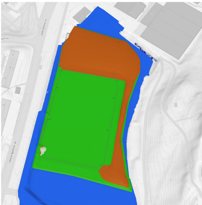
Figur 9: Utklipp fra 3D-modell som viser oppbygging av sprengsteinsmasser (rene masser) som er lagt over rensede avfallsmasser. Blått areal viser topplag av sprengsteing fra saneringsprosjektet, grønt areal viser sprengsteinfylling lagt ut i fase 1 og oransje areal viser sprengsteinsfylling lagt ut i fase 2. Omriss av planlagt 11er- og 7er-bane er indikert.
