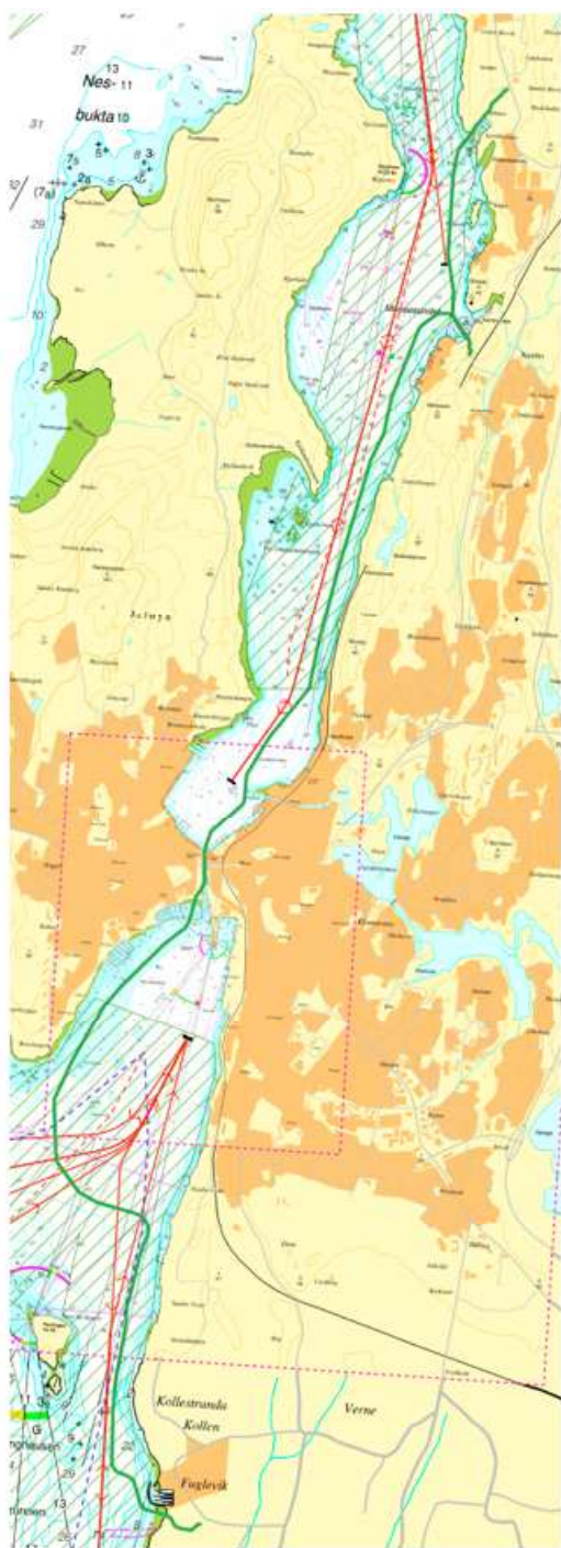
Figur 2. Til venstre: Sjøkart som viser traséen for overføringsledning (grønn linje), hovedled (rødstiplet linje), biled (blåstiplet linje), farledsareal (grønn skravur og referanseruter for navigasjon (rød linje). Kilde: COWI og Kystinfo.
