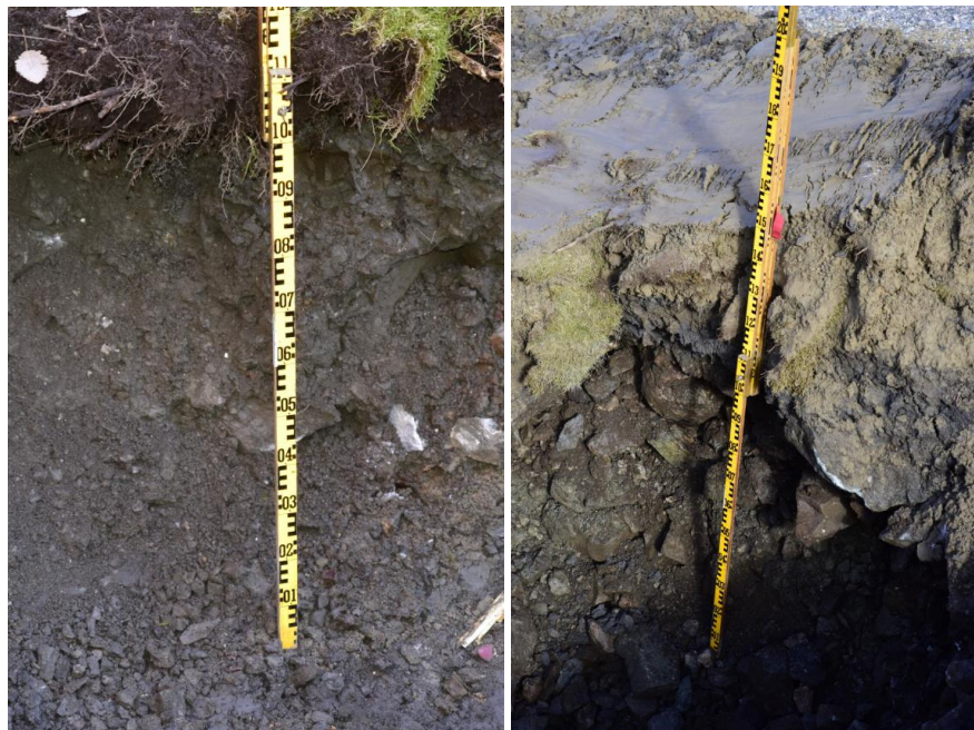
Figur 3: Bilder tatt av COWI fra felt ved Kambo RA den 26.03.2026. Til venstre vises prøvesjakt fra K-P1 og til høyre er prøvesjakt fra K-P4. Bildet til høyre viser silt/leire i massene nærmest sjøen.
