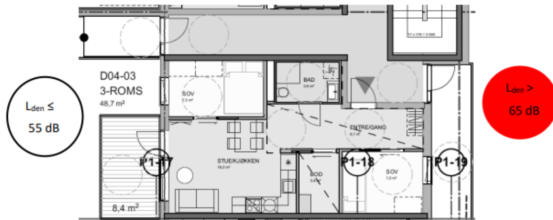
Figur 17 - Eksempel på planløsning som tilfredsstiller foreslåtte krav til støyutsatt enhet.
