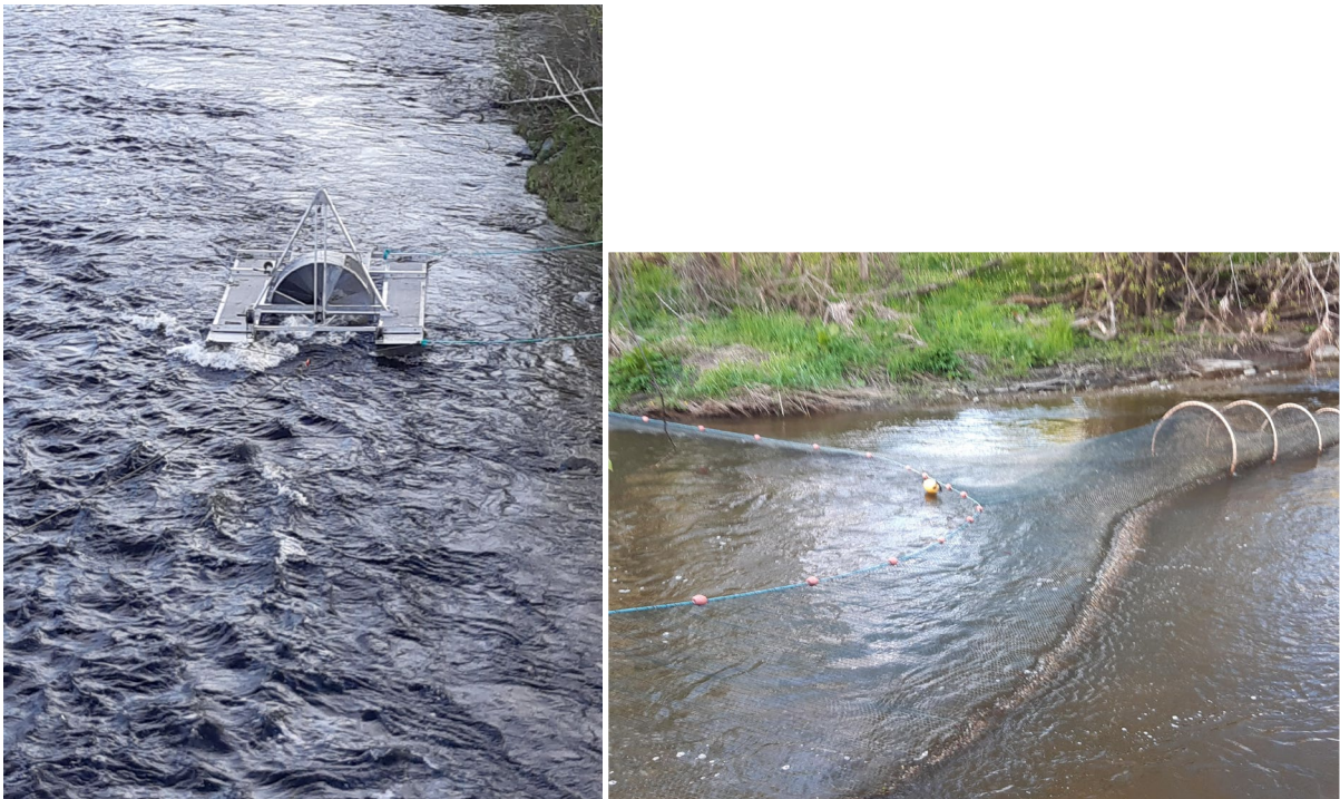
Bilde 2: Smoltskrue (til venstre) i drift ved Sona bru i Stjørdalselva og smoltruse (til høyre) med leddegjerde i Gråelva. Foto: Jan Grimsrud Davidsen
