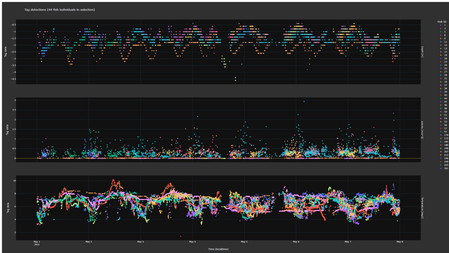
Figur 37: Skjermbilde av program brukt for sanntids-overvåkningen av merket fisk ved Hellstranda. Figurene som viser fiskenes svømmedybde (øverst), akselerasjon (midt) og temperatur (nederst) i perioden 1. – 8. mai 2021. Da det ble merket et større antall fisk med kun temperatursensor enn med kombinasjonen av sensorer for dybde, akselerasjon og temperatur, inngår det data fra flere individer på temperaturplottet enn på de to øvrige plottene.
