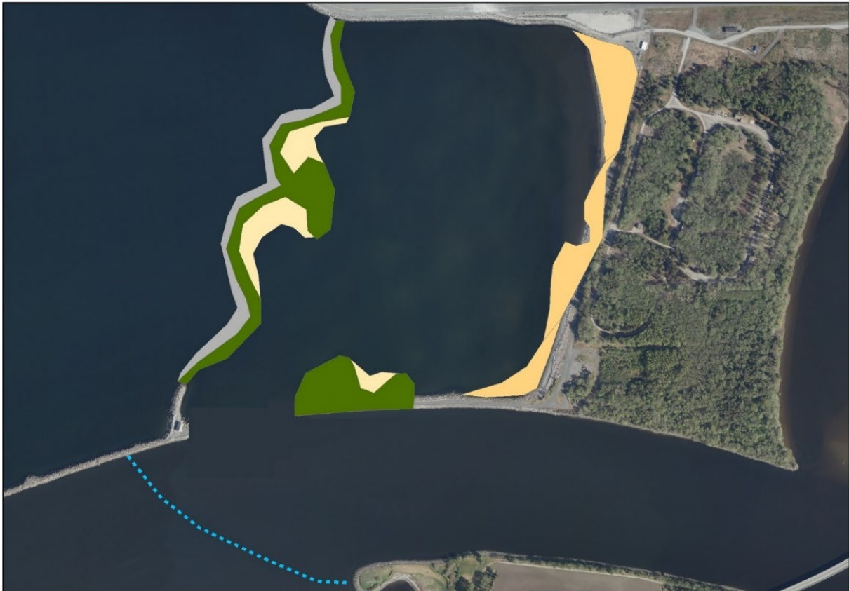
Figur 45. Skisse av mulig utforming av alternativ 2, hvor en del av eksisterende molo er fjernet og ny mer natur-lik fylling/molo/ør er lagt nordover til flystripa. Grønne områder representerer vegetasjon, gule er grunne sandområder, og oransje områder er potensielle arealer for strandeng/sump. Stiplet blå linje illustrerer en potensiell terskel for å øke ferskvannspåvirkningen i det nye området. Figur lånt fra Davidsen mfl. (2020a).
