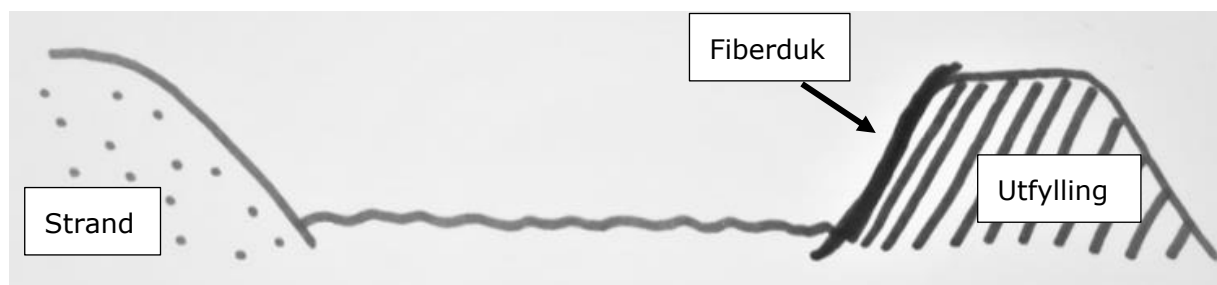
Figur 14 Skisse som viser bruk av fiberduk ved utfylling. Først etableres det siltgardin(er) rundt planlagt utfyllingsområde. Så etableres det (trinnvis) steinsjeté(r) med fiberduk. Siltgardina er plassert på utsida av tiltaksområdet under hele anleggsperioden/så lenge det ansees som nødvendig. Dette er tiltak som gjøres for å hindre partikkelspredning og fange opp evt. oljesøl på en effektiv måte. I tillegg gjennomføres det kontinuerlig overvåking av sjørret i området.
