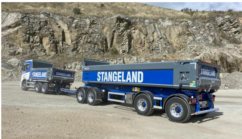
Figur 1 Steintransport med 60 tonn totalvekt. Entreprenør Stangeland
