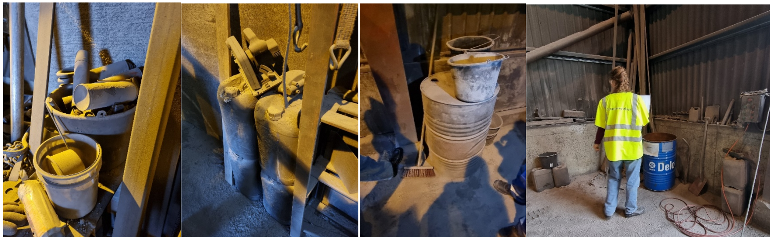
Figur 1: Farlig avfall som var lagra innendørs uten merking. Spraybokser, oljekanner og spilloljefat.
