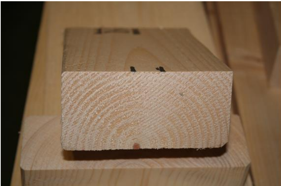
Bilde 15. Tverrsnitt med årringmønster fra skurforsøk ved Moelven Granvin av plantet Hartz gran
