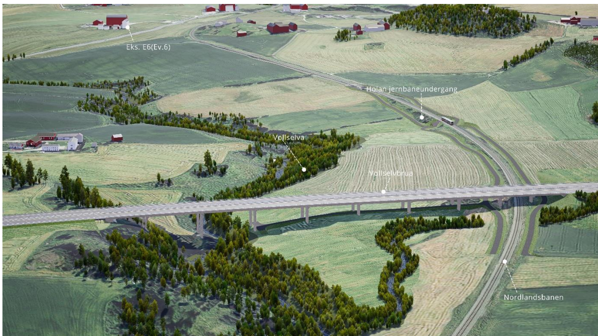
Figur 2-6 Visualisering av Vollselva. Elva løftes og erosjonssikres, og sideterrenget danderes naturligt og revegeteres. Den østlige sideravinen fylles delvis igjen, og Raudhåmmårbekken legges åpent i toppen av fyllingen og revegeteres.
