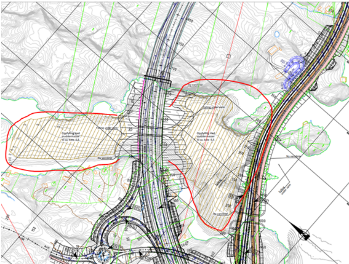
Figur 14 - Områder hvor det skal legges ut muddermasser er vist i brun skravur og ringet rundt med rød markering.
