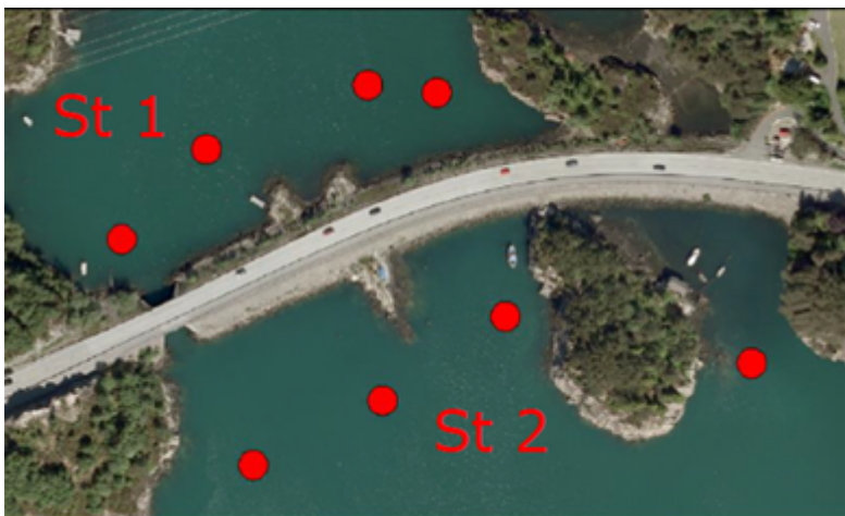
Figur 30 - Sedimentundersøkelser utført ved Arefjordpollen på hver sin side av eksisterende rv. 555. Det ble tatt ut 4 prøver for hver stasjon [23].
