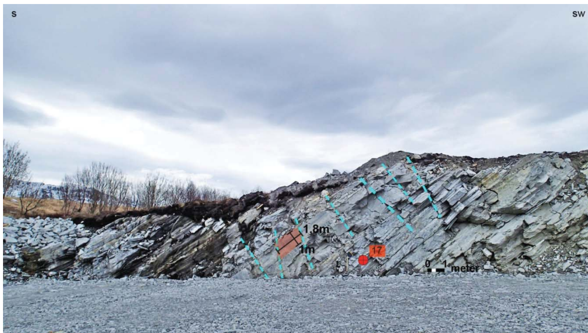
Fig. 12: Den sørøstlige delen av stoffen hvor prøve 17 er tatt. Merk at sprekke (i blått) forekommer tettere (med 0,5-1,5 m mellomrom) og er mer utviklet enn i andre deler av stoffen, i tillegg til at lagdelingen i bergarten er tynnere.
