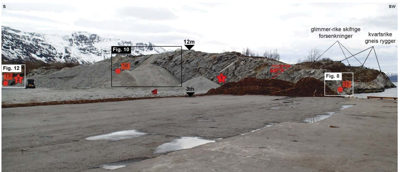
Fig. 7: Oversiktsbilde over dagens brudd i den granittiske gneisen. De røde markører (15,16 og 17) viser hvor det er tatt håndstykker, mens de røde stjernene (1 og 2) viser omtrentlig hvor det ble tatt prøver til mekanisk analyse. Strøk og fall er relativt likt over hele området (040/60). I tillegg vises detaljbilder i Fig. 8 til Fig. 13 hvor er tatt håndstykker.
