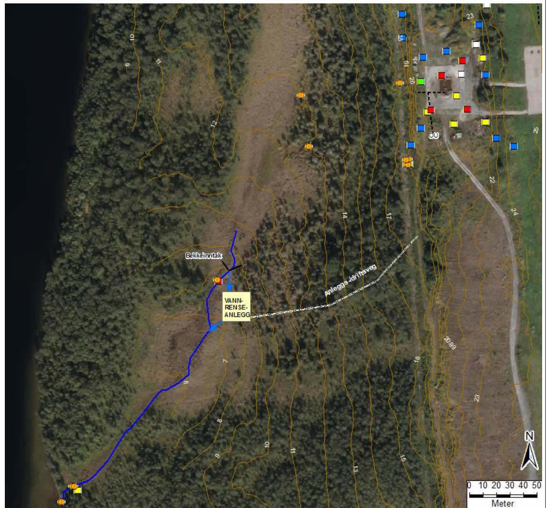
Figur 4-4: Skissert løsning for rensing av bekkevann. Det etableres anleggs-/driftsveg fra eksisterende driftsveg på lufthavnen.
