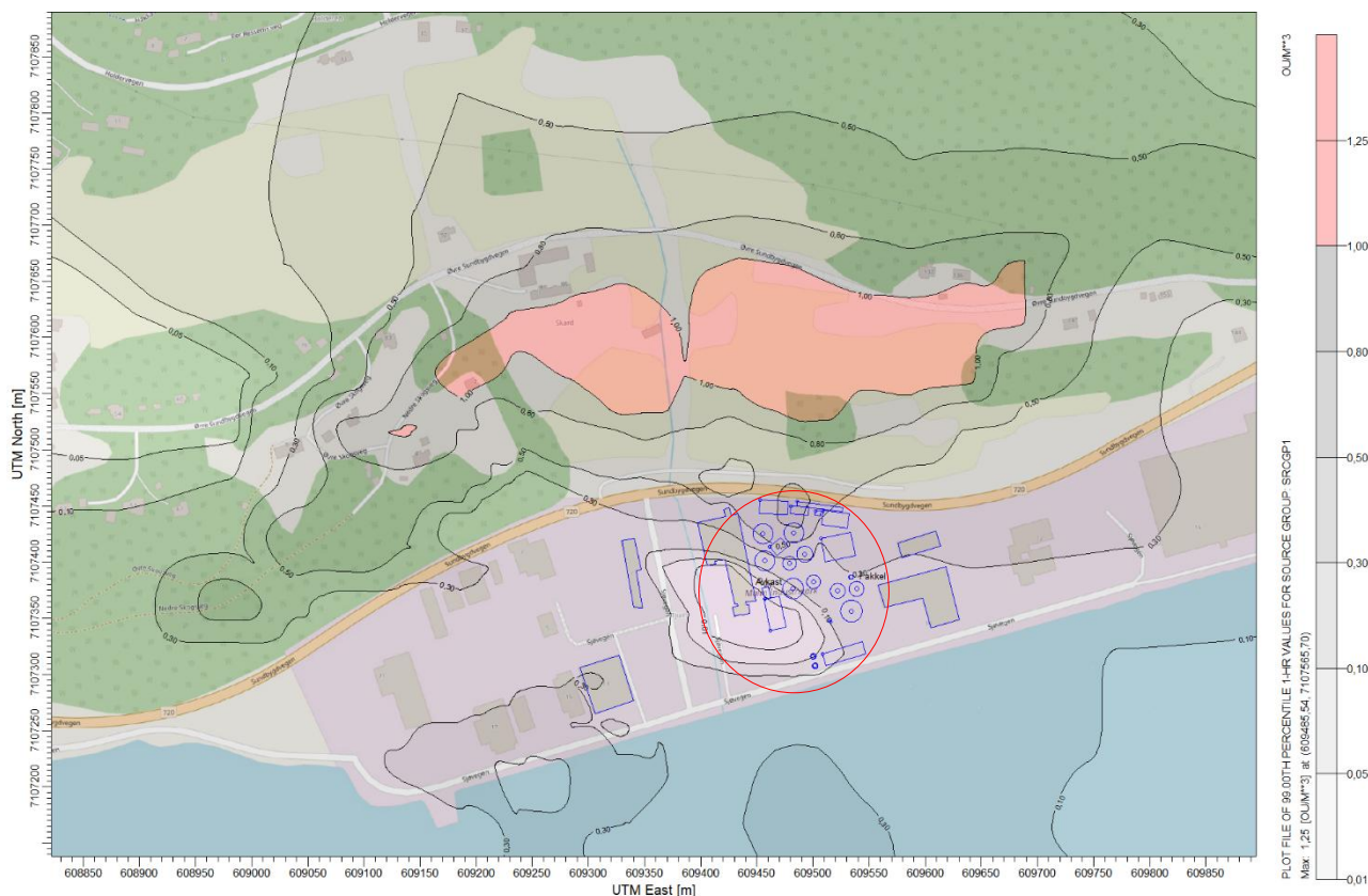
Figur 5-4. Spredningskart som viser månedlig 99 prosent timefraktil for måneden med høyest luktkonsentrasjon hos nabo ved et utslipp fra avkastet på 2000 ouE/m³. Området hvor biogassanlegget er planlagt er markert med rød sirkel. Spredningskartet viser spredning av lukt med meteorologi for desember 2022. Det er et område med overskridelser nord for anlegget og en bolig får overskridelse av grenseverdien, gitt i TA-3019.
