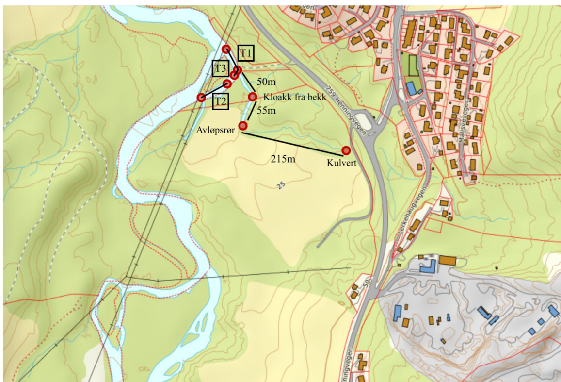
Figur 2. Figga og Ramsdalsbekken med befaringrute hvor undersøkte strekninger er avmerket. Røde punkter refererer til start og slutt for tellestasjoner og andre spesielle detaljer.
