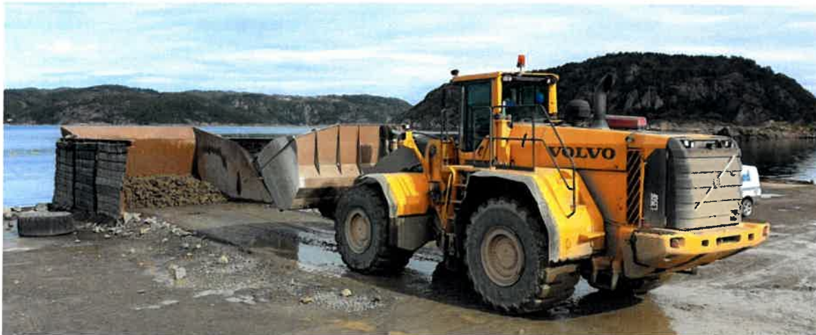
Bilde 3, Lastekasse fylles med hjullaster
