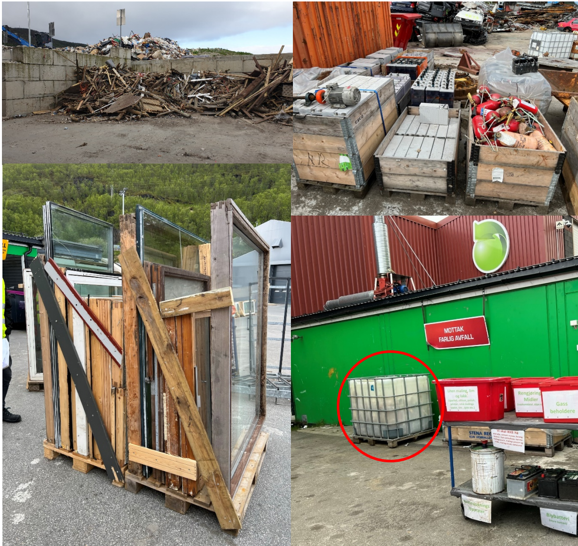
Figur 4: Viser farlig avfall lagret uten klimavern. Øverst til venstre – Impregnert trevirke, øverst til høyre – Bilbatterier (delvis skadet) og gasser i trykkbeholdere hos HRS Metallco AS, nederst til venstre – Klorparafinholdige isolerglassruter som hadde stått ute i 2-3 dager, nederst til høyre – IBC-konteiner uten tak til oppbevaring av lyspærer.
