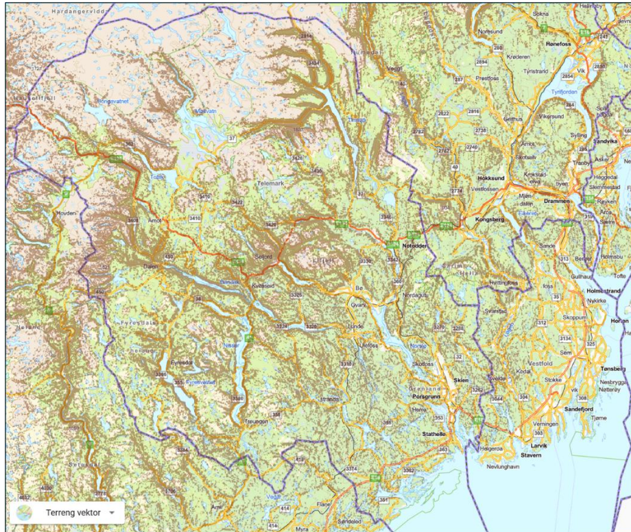
NVE temakart: Aktsomhetskart for jord- og flomskred. De brune markeringene i kartet viser områder med mulighet for jord- og flomskred.
