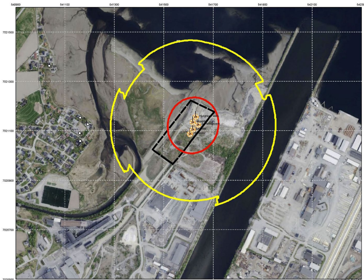
Figur 2 Støysonekart og fasadenivåer L_{den} man-fre. Gul linje er utstrekning av L_{den} \geq 55 dB og rød linje er utstrekning av L_{den} \geq 65 dB. Sort linje er Planområde gjenvinningsanlegg. Flybilde tatt mai 2018
