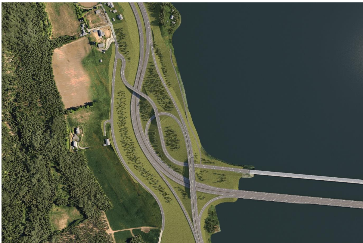
Figur 5-10: Kryssløsning for E6 og rv. 4 i alternativ 1 hvor nytt kryss vil ligge på omtrent samme sted som dagens kryss med rv. 4. Kilde: COWI AS
