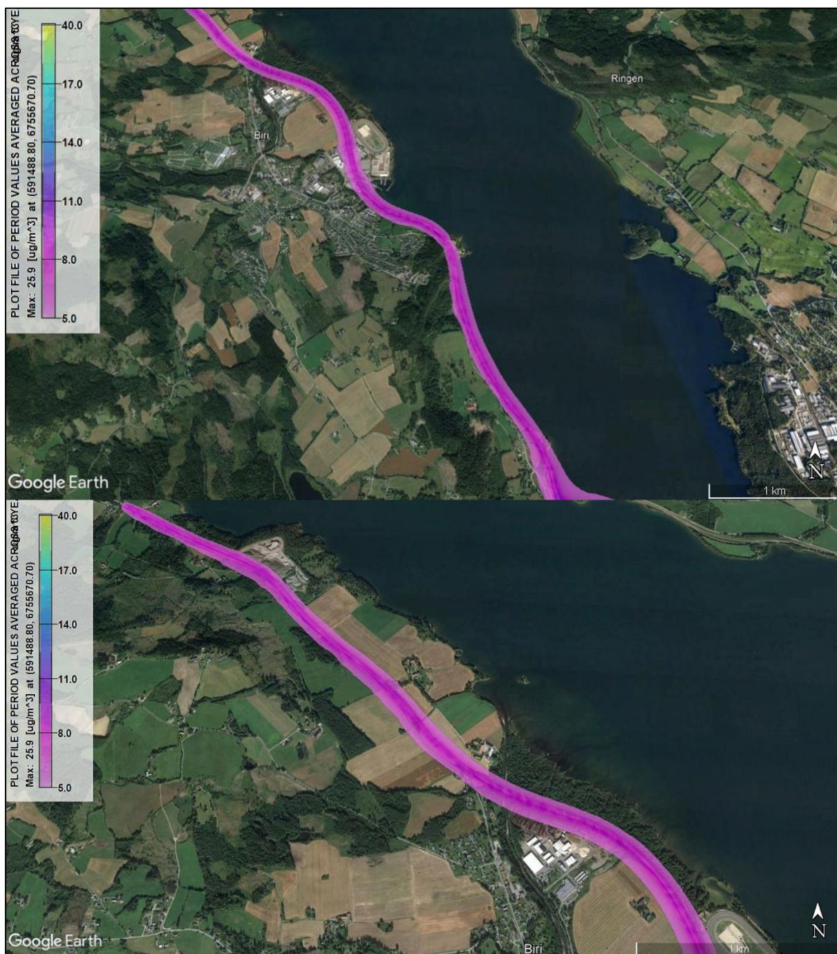
Figur 5-15: Spredningskart i form av \text{NO}_2 vintermiddel ( \mu\text{g}/\text{m}^3 ) for 0-alternativet (2050) for delstrekning Fremstadodden–Roterud. Overskridelse av gul sone skjer ved 40 \mu\text{g}/\text{m}^3 . Spredningskartet er presentert i Google Earth.
