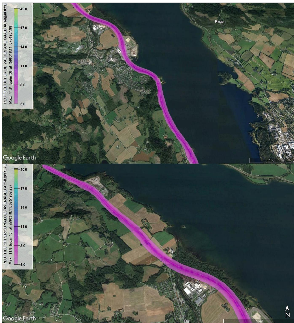
Figur 5-18: Spredningskart i form av NO 2 vintermiddel (µg/m 3 ) for KDP-alternativet (2050) for delstrekning Fremstadodden-Roterud. Overskridelse av gul sone skjer ved 40 µg/m 3 . Spredningskartet er presentert i Google Earth.
