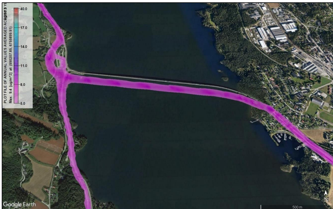
Figur 5-8: Spredningskart i form av NO 2 årsmiddel (µg/m 3 ) for alternativ 1 (2050) for delstrekning Moelv–Fremstadodden. Overskridelse av rød sone skjer ved 40 µg/m 3 . Spredningskartet er presentert i Google Earth.
