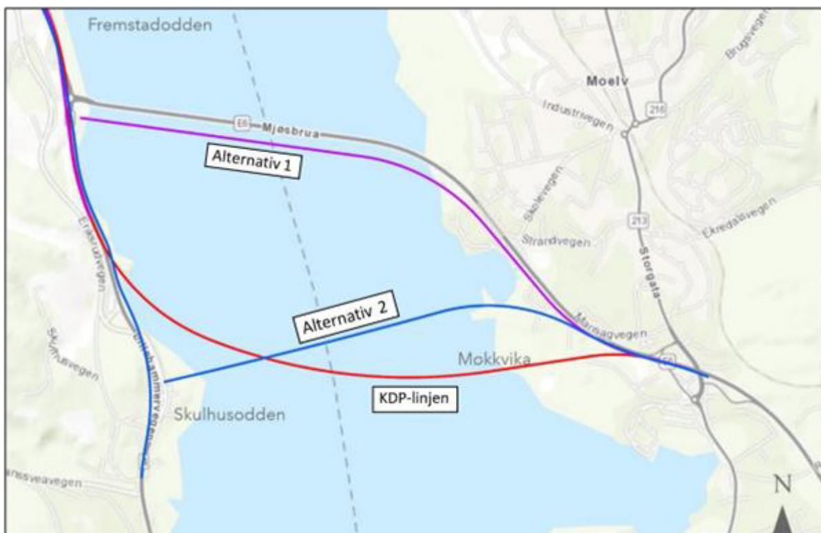
Figur 2-3: Prosjektalternativene mellom Moelv-Fremstadodden er vist med lilla og blå linjer. Kommunedelplanens trasé for ny Mjøsbru er vist med rød linje. Kilde: COWI AS.
