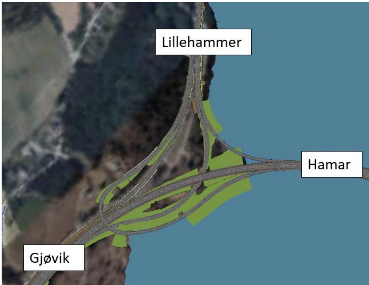
Figur 8-5: Kryssalternativ C: Trompetkryss med prioritet på trafikkstrømmen Hamar – Lillehammer. Kilde: COWI AS
