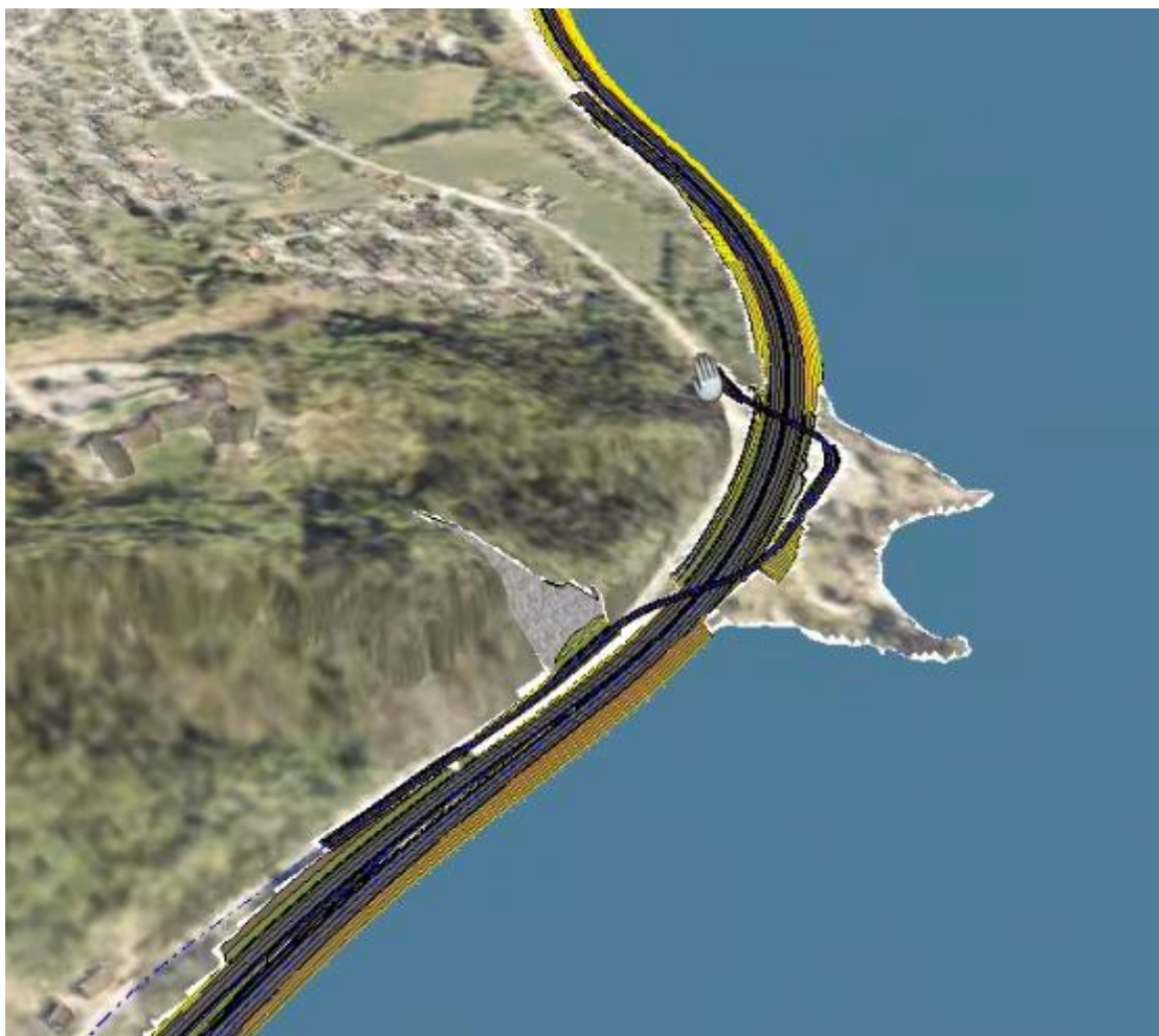
Figur 10-7 Skisse av konsept B for passering av Kremmerodden. Kilde: COWI AS
