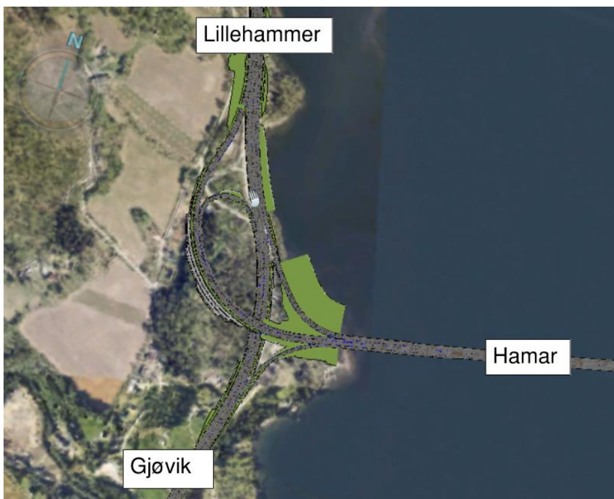
Figur 8-3: Kryssalternativ A: Trompetkryss med prioritet på trafikkstrømmen Gjøvik – Lillehammer. Kilde: COWI AS
