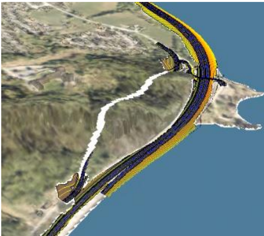
Figur 10-9 Skisse av konsept D for passering av Kremmerodden med fylkesveien i tunnel. E6 er her vist på samme måte som i konsept B, men konsept C er også en mulighet. Kilde: COWI AS
