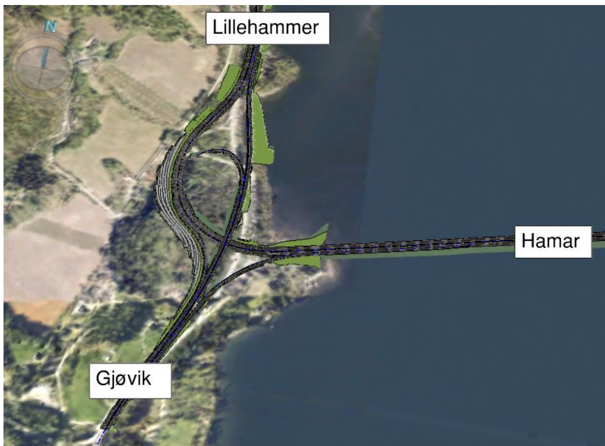
Figur 8-4: Kryssalternativ B: Trompetkryss med prioritet på trafikkstrømmen Hamar – Lillehammer. Kilde: COWI AS
