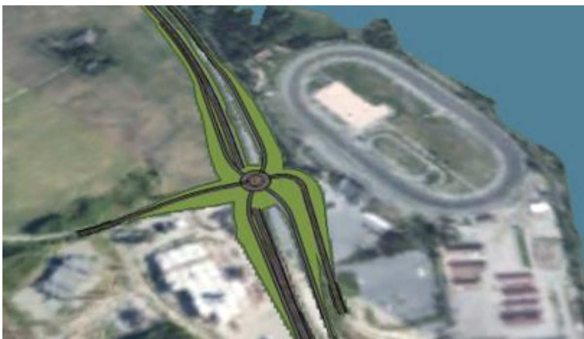
Figur 11-4 Kryssvariant i Skumrudvegen med E6 i kulvert under en mindre rundkjøring. Kilde: COWI AS
