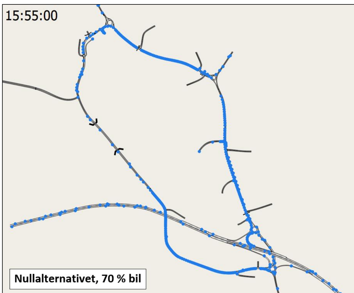
Figur 5-12: Beregnet køsituasjon ca. kl. 15:55 i nullalternativet med lave bilprognoser (70 %). Blå prikker representerer kjørende. (Illustrasjon: Aimsun)
