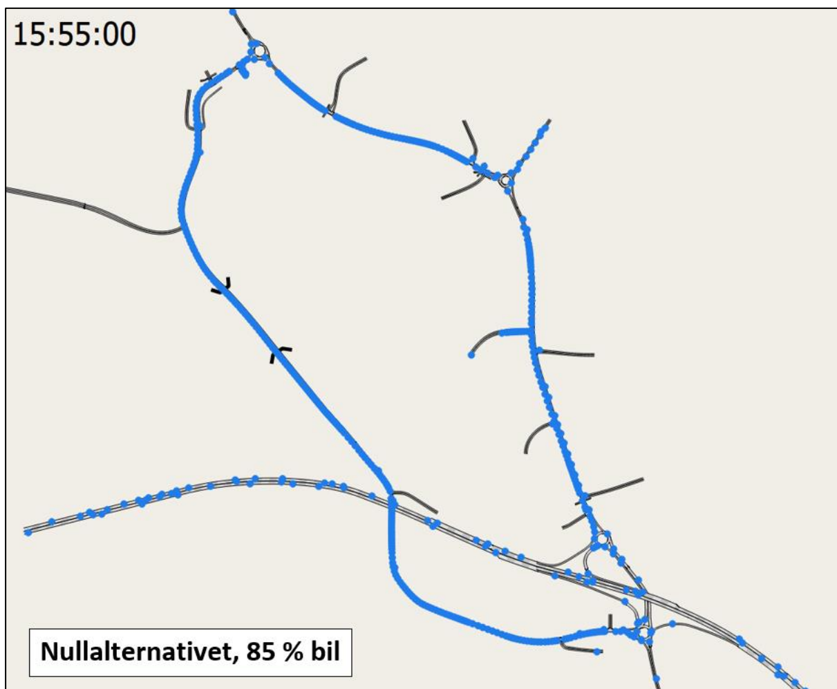
Figur 5-13: Beregnet køsituasjon ca. kl. 15:55 i nullalternativet med høye bilprognoser (85 %). Blå prikker representerer kjørende. (Illustrasjon: Aimsun)
