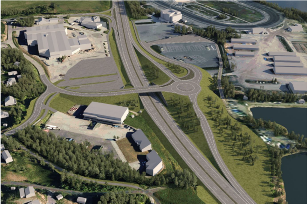
Figur 7-30: Toplanskryss på Biri med sammenkobling til lokalt veinett. Kilde: COWI AS
