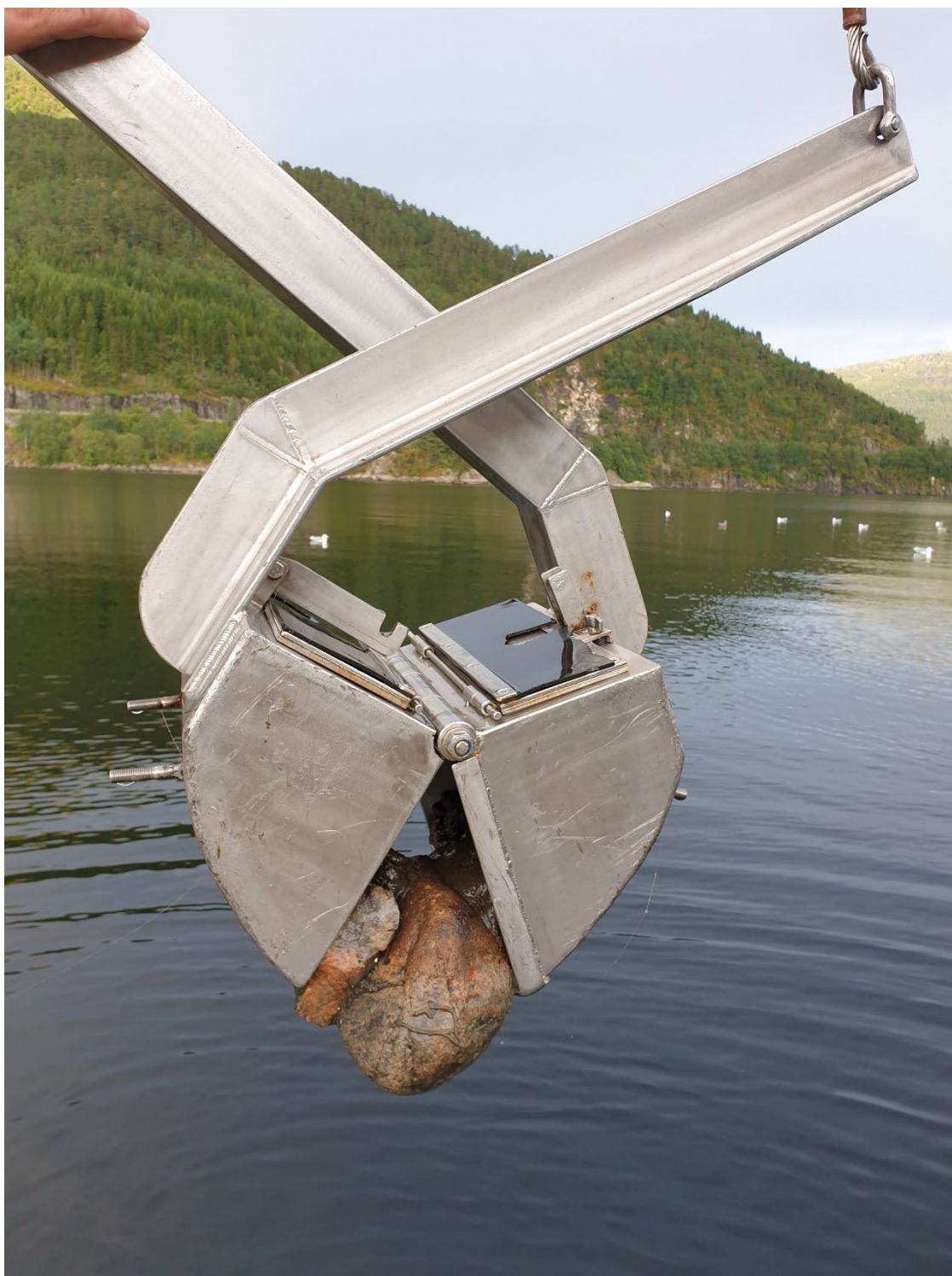
Figur 4 0,1 kvadratmeter VanVeen grabb benytte til innsamling av bunnsediment og fauna i Førdefjorden Indre juli 2023. Avbildet prøve ble ikke godkjent. Foto: Lars-Henrik Larsen Akvaplan-niva.
