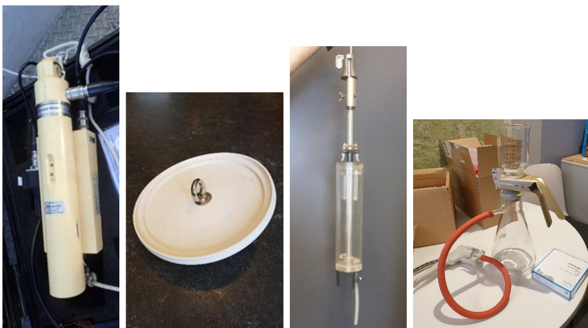
Figur 3 Utstyr benyttet til måling og prøvetaking i vannsøylen i Førdefjorden Indre 2023-24. Fra venstre: Sensordata CTDO-sonde for registrering av temperatur, saltholdighet, oksygeninnhold og trykk, sikteskive for måling av siktedyp, vannhenter og filtreringsenhet for vannprøver.
