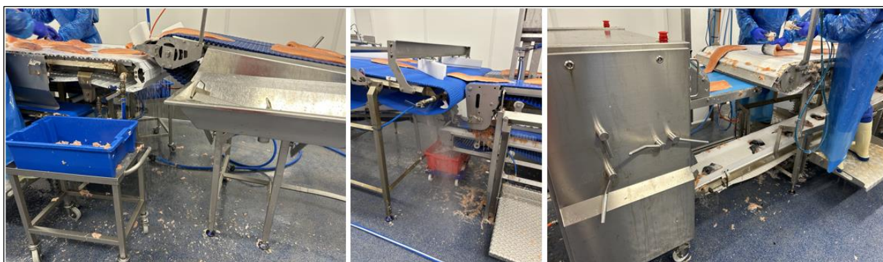
Figur 5 - Avskjær som ender på gulv. Bilder fra trimming og skinning.
