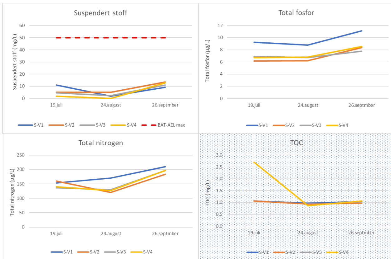
Figur 10. Grafene viser hvordan konsentrasjoner av BAT-AEL-parametere endrer seg i tid i alle prøvepunktene. Grafene viser gjennomsnittverdier fra tre dybder per prøvepunkt. TOC er skravert da dette erstatter KOF i resipienten. Merk at øvre grense for BAT-AEL er betydelig høyere for total fosfor og totalt nitrogen, i hhv. 2000 µg/l og 20 000 µg/l, og at disse vises ikke på figurene.
