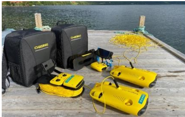
Figur 1 Undervannsdrone (til venstre) og ekkolodd (til høyre) brukt ved kartlegginga i 2021.
