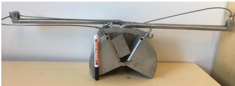
Figur 5. Liten VanWeen grabb ble benyttet til innsamling av prøvene.
