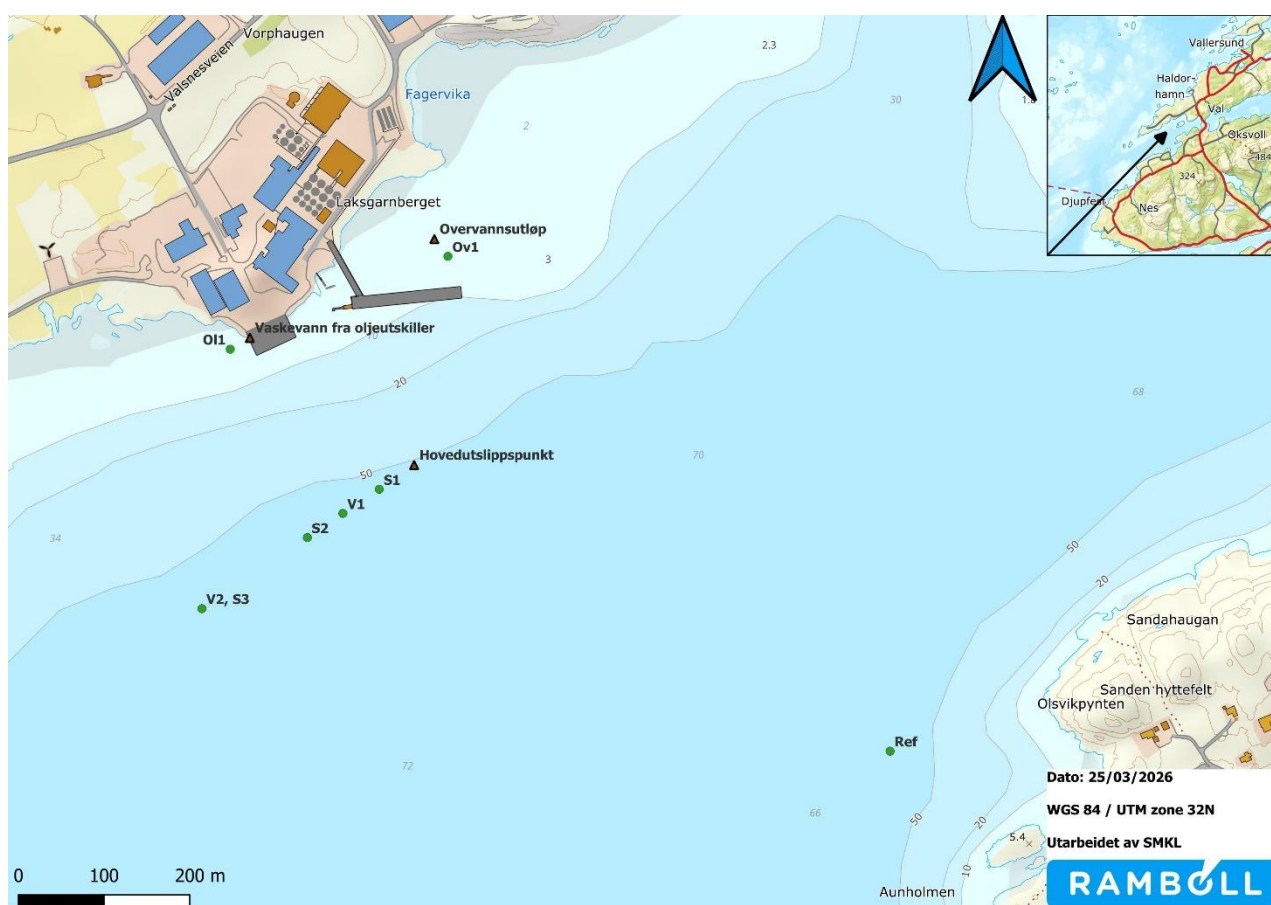
Figur 4. Stasjonsnett for resipientundersøkelse. Stasjonsnettet er satt i et transekt iht. forventet strømrretning. Lille trekanter viser utslippspunktene og grønne sirkler viser plasseringen av stasjonene. Prøvetakingsparametere ved de ulike stasjonene er beskrevet i tabell 3. Kartet er nordlig orientert.
