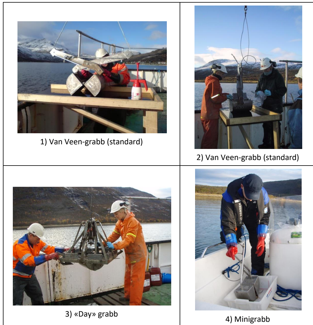
Figur 2-2: Standard van Veen-grabb med «inspeksjonsluker» hvor prøver blir tatt ut (bilde 1 og 2), «day» grabb på stativ (bilde 3) og håndholdt minigrabb (bilde 4).
