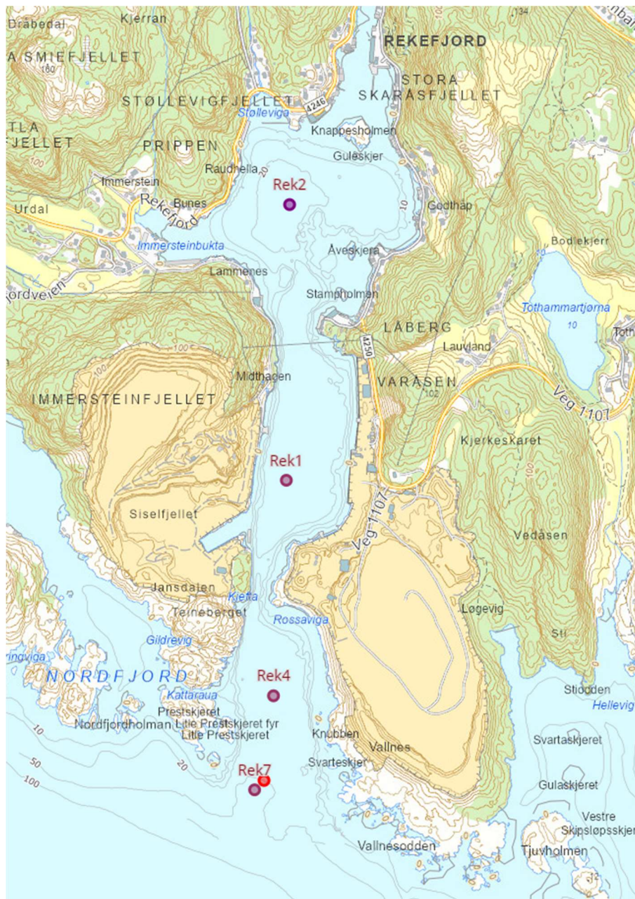
Figur 11: Lilla prikker: Utvalgte målelokaliteter der CTD målinger (ref) av saltholdighet og temperatur er sammenlignet med modellresultater. Røde prikk: Foreslått utslippspunkt.
