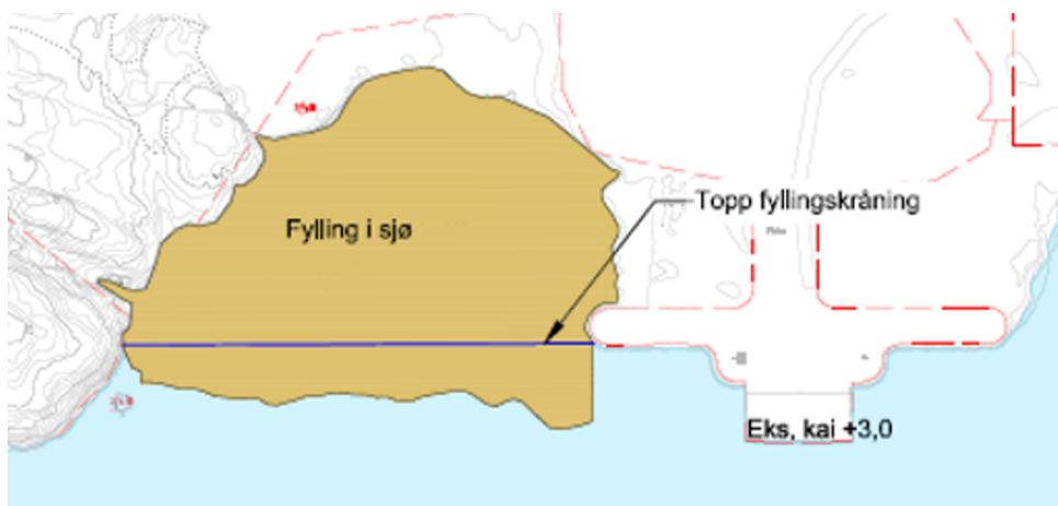
Figur 8: Utsnitt av modell som viser planlagt plassering og utstrekning av fylling med fyllingsfot.
