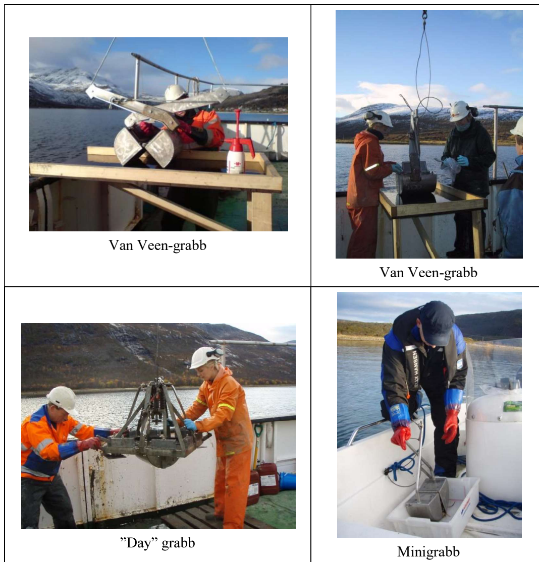
Figur 2 Standard van Veen-grabb med «inspeksjonsluker» hvor prøver blir tatt ut, «day» grabb på stativ og håndholdt minigrabb.
