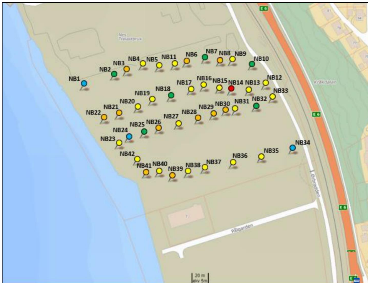
Figur 2: Oversikt over sjakter gravd under miljøtekniske undersøkelser utført av Miljøvakta i mai 2022 [5]. Farger viser høyeste tilstandsklasse for blandprøver fra overflate til dyp på 3-4 m. Tilstandsklassene representerer hovedsakelig forurensningsgrad for alifater >C12-C35.
