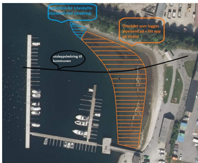
Figur 2: Raudt illustrerer oppmudra massar, og området markert med rosa viser kor det skal dumpast. Blått viser området som skal fyllast ut med naturstein, medan oransje viser arealet som skal fyllast ut med skjelsand. Utsleppsleidninga er òg teikna inn.
