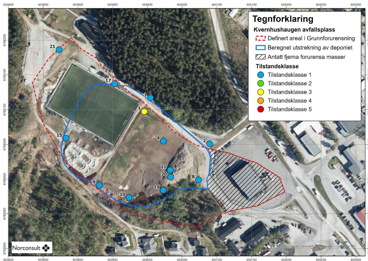
Figur 14 Undersøkte prøvepunkter i toppdekket til Kvernhusaugen avfallsdeponi den 25. april 2022. Prøvepunktene er fargelagt med høyest påviste tilstandsklasse jf. TA-2553/2009.
