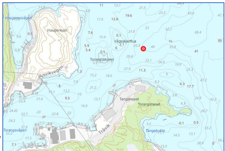
Figur 1: Utsleppspunkt for avløpsvatn skal vere på -40 meter.
