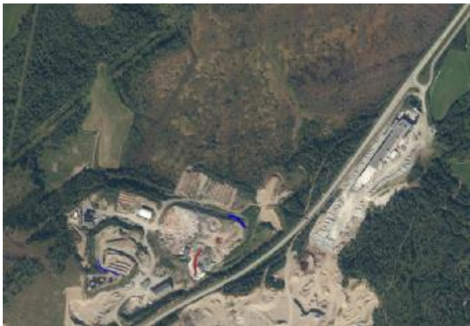
Fig. 2 viser hvor det i 2019 ble påvist gass ved måling på overflaten. Rød farge indikerer kraftigste utslag på måleren.
