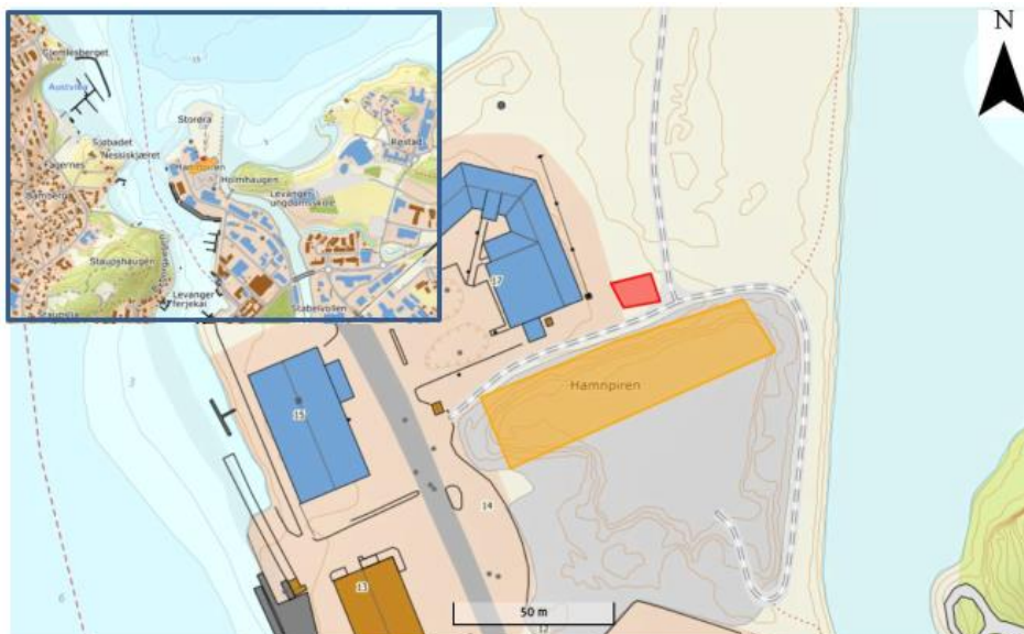
Figur 1: Omtrentlig utbredelse av snødeponiet på Storøra er vist som et oransje rektangel. Det røde feltet angir deponiets laveste punkt som benyttes som infiltrasjonspunkt.
