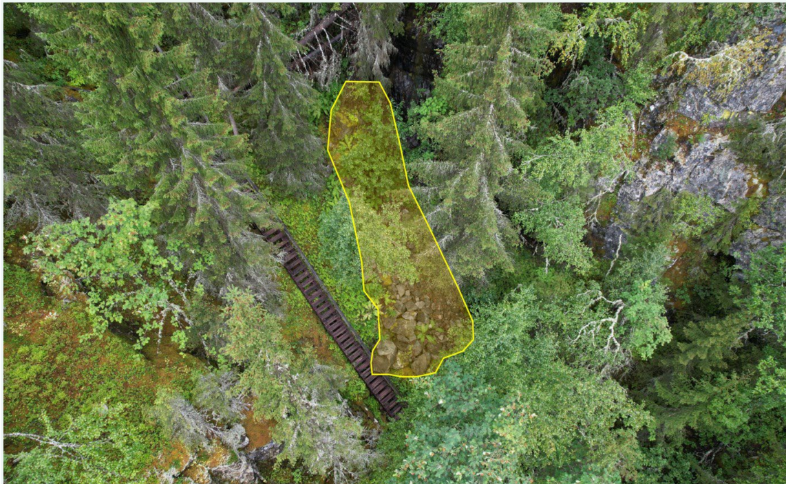
Figur 3 Bilde av tretrapp med restene av mindre flomskred (Skred AS)
